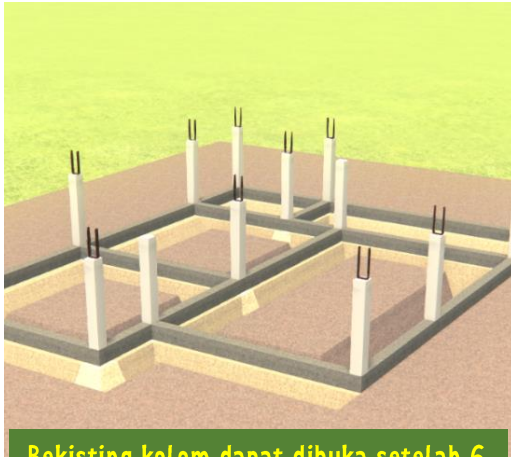
Bekisting kolom dapat dibuka setelah 6 hari
